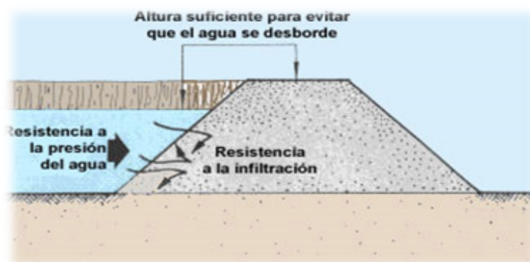
Figura 10: Partes de un dique.
