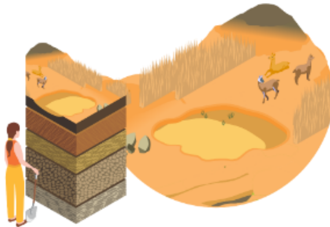
Figura 5: Calicata: Hoyo que se hace en el suelo como técnica para determinar composición del suelo. Fuente: Najar. R. 2022.
