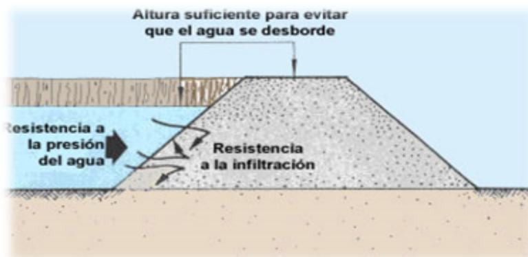
Figura 10: Partes de un dique.
